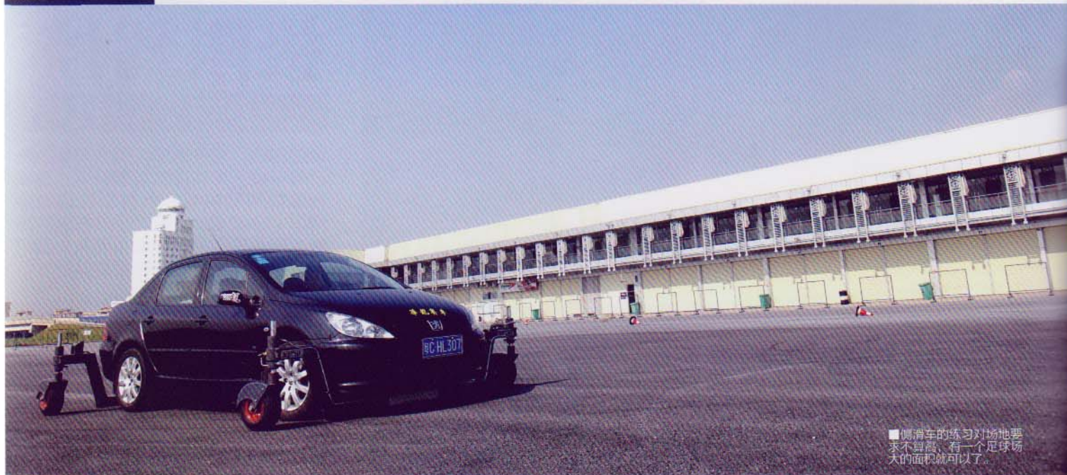
■前后轮的调整都是电脑控制的，前后轮各可以完成10级调整。
