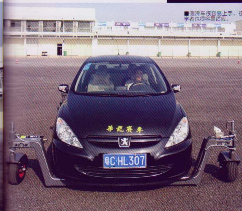
■连接组件是直接连接在悬挂上的，通过抬升悬挂来改变轮胎接地面积。
